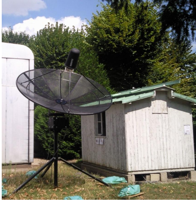
FIGURE 3 – Notre antenne : 2,3 m de diamètre
